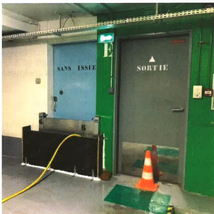
Test d'étanchéité d'un batardeau - © PariSeine
