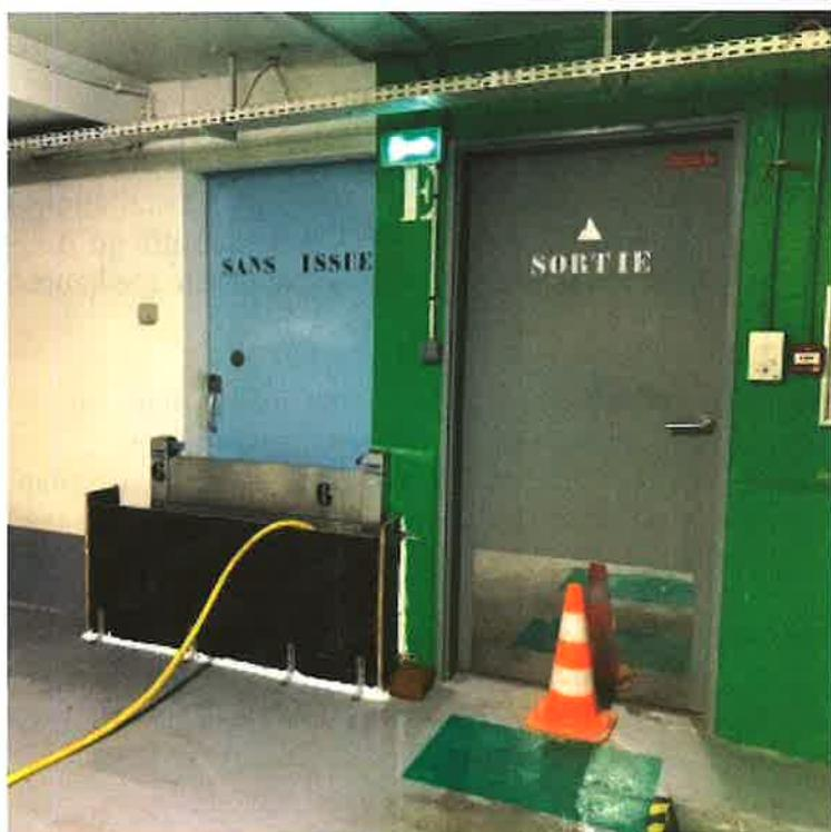
Test d'étanchéité d'un batardeau - © PariSeine
