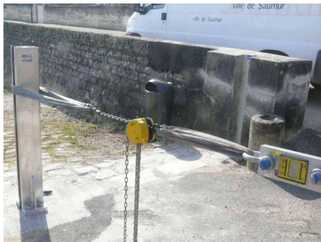
Test traction 420 kg Hauteur de protection h=1200 mm
