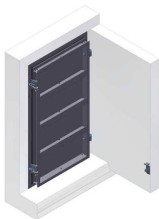
Fig. 1.2.4 Porte anti-inondation fermée et verrouillée
