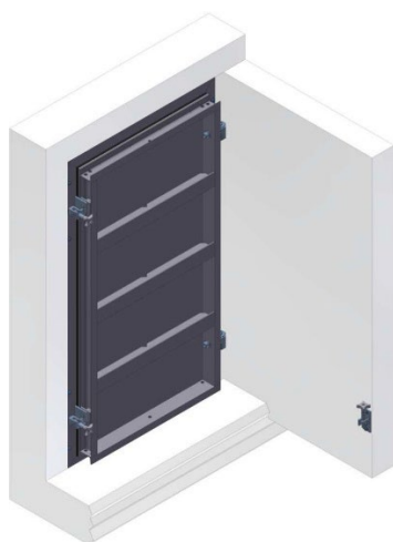
Fig. 1.1.4 Porte anti-inondation fermée et verrouillée
