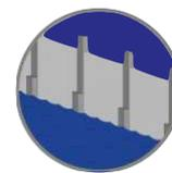
En supplément à la pression hydrostatique (plus une marge de sécurité de 35 %), une charge supplémentaire de 10/20/30 KN/m<sup>2</sup> est appliquée sur le mètre supérieur de la hauteur de retenue d'eau.
