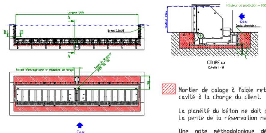
Plan des Réservations béton nécessaire pour l'intégration du Flo-Lift H
